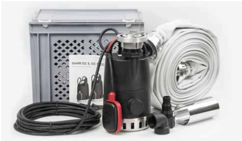
Grundfos MULTIBOX er en alt-i-en akut drænløsning, som anvendes i akutte situationer. Løsningen er kompakt, let at opbevare og kan sættes i drift på få minutter. Sættet indeholder en UNILIFT CC-pumpe, 15 meter forstærket slange, adaptore og strømkabel samlet i en slagfast boks, som også filtrerer vandet og dermed mindsker risiko for tilstopning.
